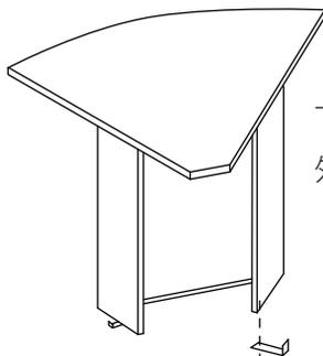
下連結金具は平カウンターの外装脚に挿入します
