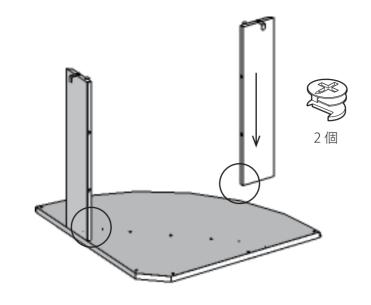
○部分の裏側に カムロック凹を挿入し 右側に約 90 度 回転させて固定します
