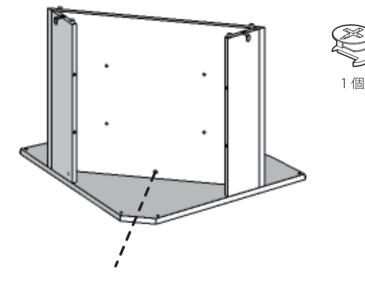
点線部分に カムロック凹を挿入し 右側に約 90 度 回転させて固定します
